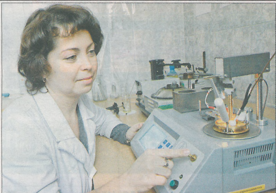
Инженер-химик I категории Елена Лискова определяет температуру вспышки топлива в закрытом тигле.
